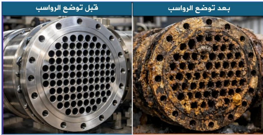
الشكل (2-28): حزمة أنابيب مبادل حراري قبل وبعد توضع الرواسب
