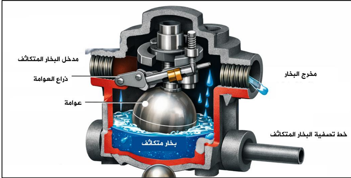
الشكل (2-38): مبدأ عمل مصيدة بخار الماء
