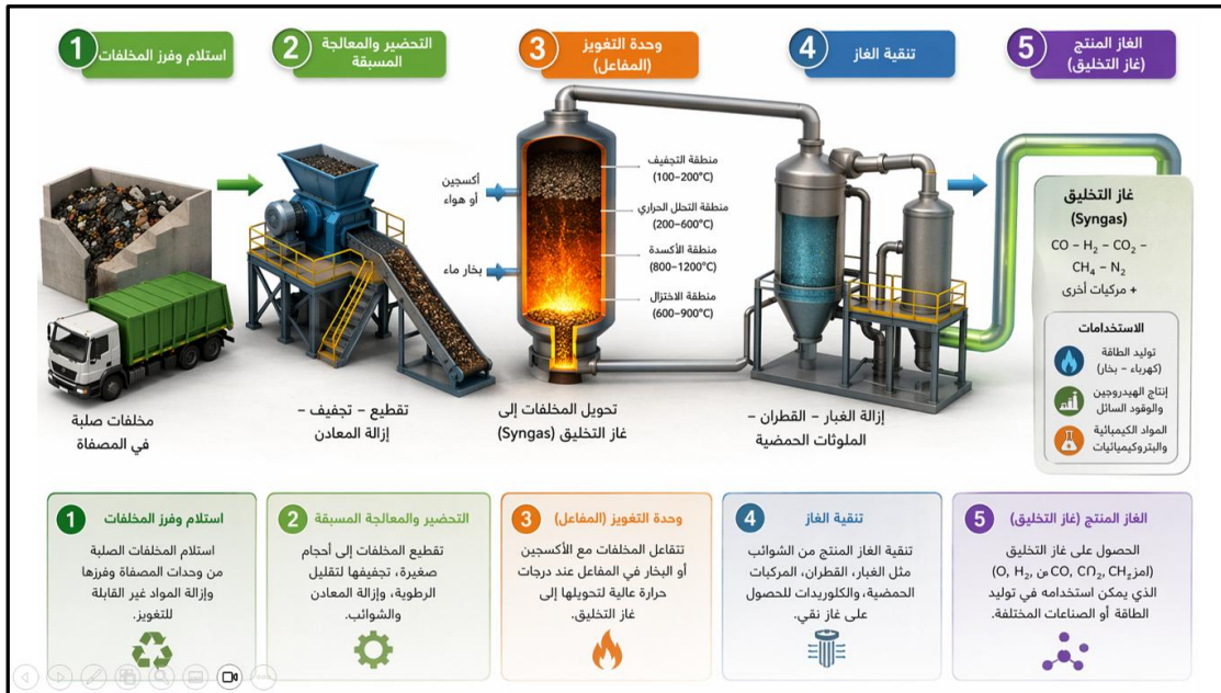
الشكل (2-25): عملية تحويل مخلفات عمليات التكرير إلى هيدروجين ووقود غازي
