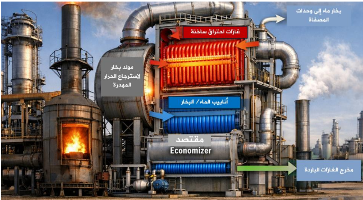
الشكل (2-35): استرجاع الحرارة من غازات مدخنة المرجل البخاري
